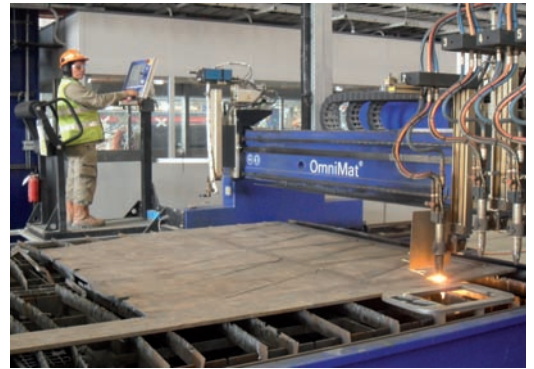
أعمال الحداة وتصنيع مداخل الحوض الجاف
